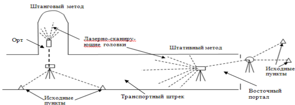
Рисунок 24 – Методы привязки сканирующей головки к координатной сетке рудника
