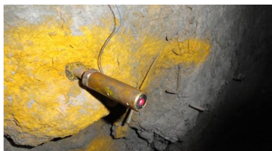
Рисунок 19 – Штуцер для лазерного указателя и сам лазерный указатель установленный в выработке.
